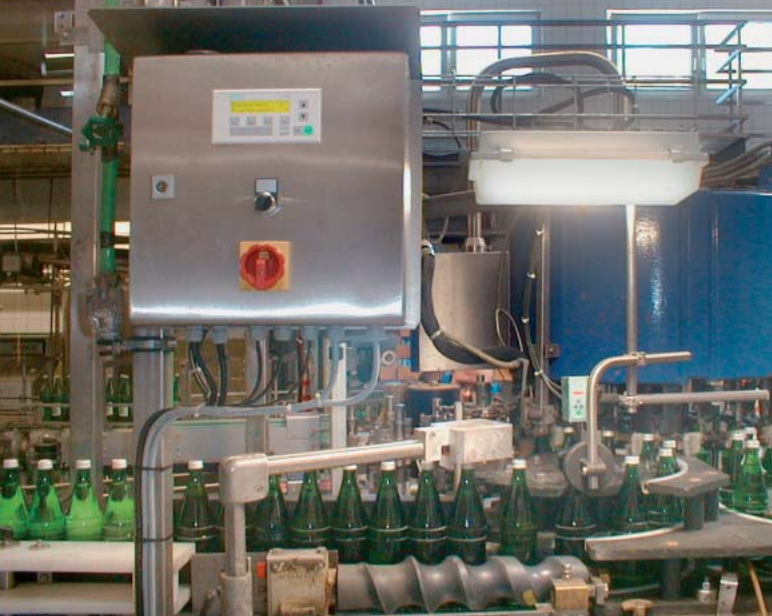
Eine Kompaktsteuerung Simatic S7-200 mit schnellem Zählengang und ein leicht bedienbares Textdisplay TD200 von Siemens Automation and Drives runden die kostengünstige Gesamtlösung ab.
