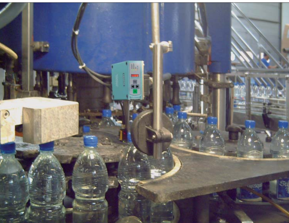
Produktive Prozesssicherheit: Ein Farbflächensensor Simatic MV220 sorgt dafür, dass deckellose PET-Flaschen vor dem Etikettieren zuverlässig aussortiert werden.
